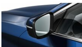
Зовнішнє ліве дзеркало заднього огляду з автоматичним затемненням S04T8
